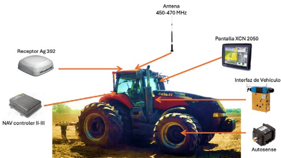
FIGURA 9: Componentes de un sistema de guiado integrado o hidráulico
