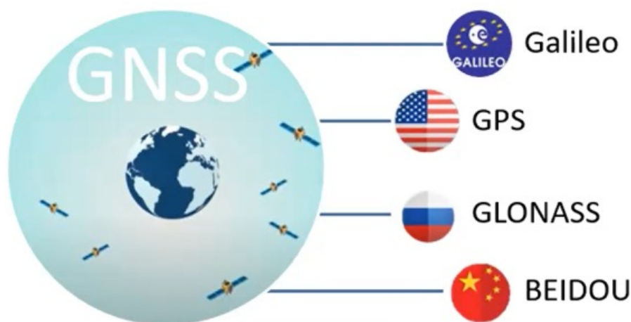
► FIGURA 2: Sistemas satelitales que componen el sistema GNSS
