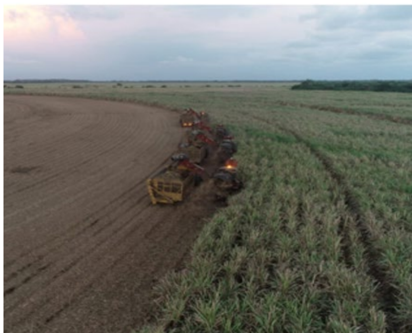
FIGURA 17: Uso de piloto automático en cosecha mecanizada
