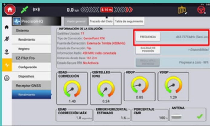
FIGURA 12: Corrección vía radio CMR, HDOP y YDOP
